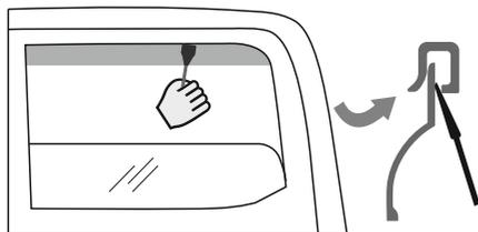
Per una migliore installazione del deflettore e un'adesione ottimale tra il nastro e la superficie della guarnizione in gomma, si consiglia di utilizzare la spatola di plastica, muovendola lentamente tra la guarnizione in gomma interna del finestrino e il deflettore.
