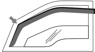
4. Desplace el deflector hacia adelante, encajando completamente el marco en el riel. Asegúrese de que el deflector está colocado sobre el marco inferior de la ventanilla.
