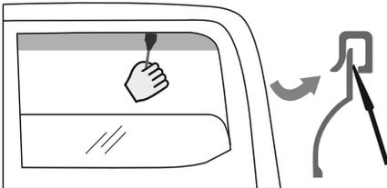
5. Pour assurer une meilleure installation du déflecteur et une meilleure adhérence entre le ruban et la surface du joint en caoutchouc, il est vivement recommandé d'utiliser la lame en plastique en la déplaçant lentement entre le joint en caoutchouc intérieur de la fenêtre et le déflecteur ;
