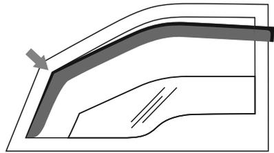
Schieben Sie den Deflektor nach vorne, so dass der Deflektorrahmen vollständig in den Kanal passt. Vergewissern Sie sich, dass der Deflektor über dem unteren Scheibenrahmen angebracht ist.
