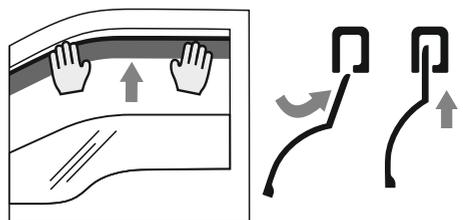
6. En commençant par la partie avant du déflecteur, insérez-le dans le canal de la fenêtre.
