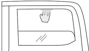
Vergewissern Sie sich, dass die Autoscheiben sauber und trocken sind. Als nächstes senken Sie die Seitenscheiben vollständig ab und reinigen Sie die Innenfläche des Scheibenkanals mit einem Alkoholtupfer vom Fett.
