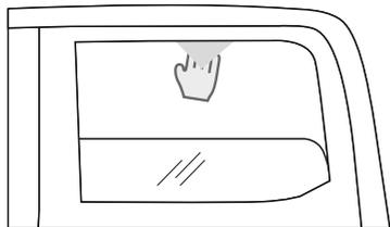
Assicurarsi che i finestrini dell'auto siano puliti e asciutti. Quindi, abbassare completamente i finestrini laterali e rimuovere il grasso dalla superficie interna della canalina del finestrino, utilizzando una salvietta imbevuta di alcol.
