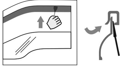
8. Pour assurer une meilleure installation du déflecteur et une meilleure adhérence entre le ruban et la surface du joint en caoutchouc, il est vivement recommandé d'utiliser la lame en plastique en la déplaçant lentement entre le joint en caoutchouc intérieur de la fenêtre et le déflecteur.
