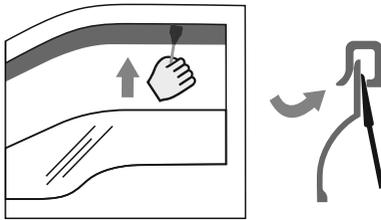
Per una migliore installazione del deflettore e un'adesione ottimale tra il nastro e la superficie della guarnizione in gomma, si consiglia di utilizzare la spatola di plastica, muovendola lentamente tra la guarnizione in gomma interna del finestrino e il deflettore.
