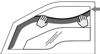
5. Doble la parte central del deflector hacia fuera e inserte la parte posterior del deflector en el riel, dejando un espacio en la parte superior.
