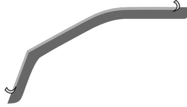
Entfernen Sie die Schutzfolie von dem Klebeband am Deflektor.
