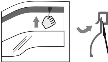
Для более качественной установки дефлектора и увеличения адгезии скотча и поверхности уплотнительной резинки используйте пластиковую лопатку, проводя ей между внутренней уплотнительной резинкой окна и дефлектором.
