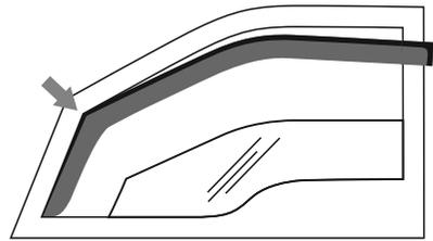
4. Déplacez le déflecteur vers l'avant, en ajustant complètement le cadre du déflecteur dans le canal. Assurez-vous que le déflecteur est placé au-dessus du cadre inférieur de la fenêtre.
