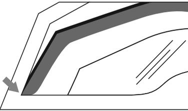
Posizionare la parte anteriore del deflettore sul telaio inferiore del finestrino, come mostrato nell'immagine.
