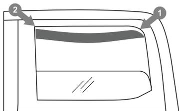
. Начинать установку дефлектора необходимо с задней части, для этого уприте заднюю часть рамки дефлектора в канал и поднимайте переднюю часть дефлектора вверх. Полностью вставьте всю рамку дефлектора в канал окна.
