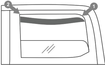
3. Le déflecteur doit être installé en commençant par l'arrière. Pour ce faire, placez la partie arrière du cadre de déflecteur dans le canal et déplacez la partie avant vers le haut. Positionner le cadre entier du déflecteur dans le canal de la fenêtre, en plaçant le cadre entre les supports de fixation et le joint en caoutchouc, comme indiqué sur l'illustration.
