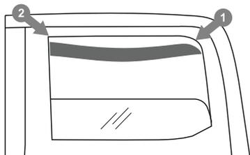
Der Deflektor muss von hinten beginnend eingebaut werden. Legen Sie dazu den hinteren Teil des Deflektorrahmens in den Kanal und schieben Sie den vorderen Teil nach oben. Positionieren Sie den gesamten Deflektorrahmen in den Scheibenkanal.
