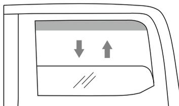
Heben Sie die Scheibe an, bis sie den Deflektor berührt. Ziehen Sie den Deflektor vorsichtig nach außen und ziehen Sie die Scheibe mit abrupten Bewegungen auf. Wiederholen Sie diesen Vorgang 4-5 Mal und lassen Sie dann die Scheibe geschlossen.
