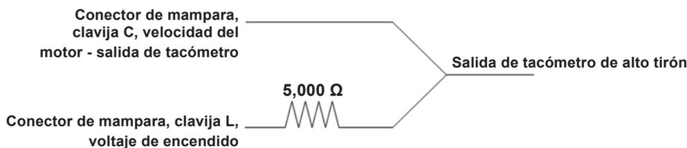
**NOTA: Cuando se conecta al Arnés de conexión y cruceo Supermatic CP no se requiere el resistor de elevación para el Controlador de transmisión.**
