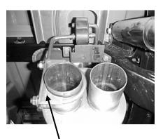
ATTACH REAR MUFFLER HANGER # F TO THE OUTLET OF THE MUFFLER ON DRIVERSIDE AND INSERT WELDED HANGER INTO GROMMET. MAKE SURE MUFFLER
