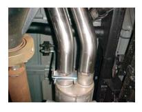
INSTALL REAR MUFFLER HANGER #E ONTO DRIVERS SIDE MUFFLER OUTLET. INSERT HANGER INTO RUBBER GROMMET LOCATED JUST BEHIND THE DRIVERS SIDE OUTLET. DO NOT TIGHTEN.
