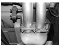
INSTALL REAR MUFFLER HANGER #E ON THE DRIVER SIDE OUTLET OF THE MUFFLER AND ILNSERT WELDED HANGER TO THE RUBBER GROMMET.
