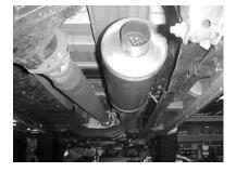
INSTALL MUFFLER ONTO THE STOCK HEADPIPE LINE-UP THE NOTCH # A. SUPPORT THE MUFFLER USING A JACK STAND. MUFFLER INLET IS LOOKING INTO LOUVERS. USE CLAMP #F TO SECURE MUFFLER. DO NOT TIGHTEN.
