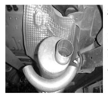
99-00 MODELS INSTALL THE MUFFLER TO HEADPIPE AND USE CLAMP #D TO ATTACH. PUSH MUFFLER TILL IT HITS THE ALIGNMENT PIN. THE MUFFLER OUTLET WILL BE POSITIONED AT ABOUT 4 -5 0'CLOCK. DO NOT TIGHTEN.
