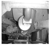
2001 MODELS INSTALL THE MUFFLER TO HEADPIPE AND USE CLAMP #D TO ATTACH. PUSH MUFFLER TILL IT HITS THE ALIGNMENT PIN. YOU WILL NEED TO ROTATE THE MUFFLER TO A 2 O'CLOCK POSITION.
