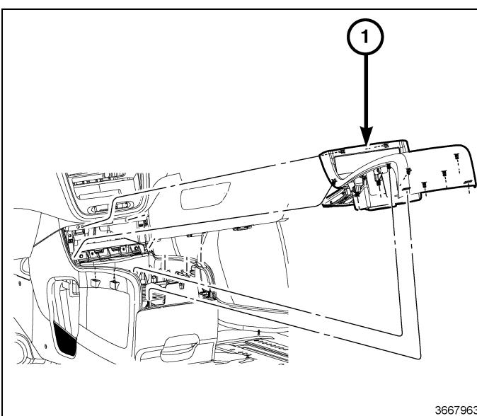
83. Tourner l'encadrement supérieur de la console (1) et débrancher le faisceau de fils (2).
