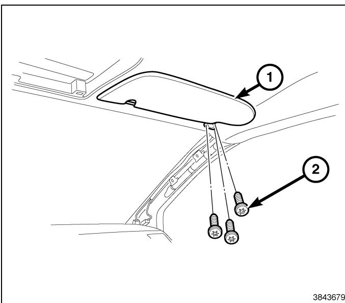
56. Retire el elemento de retención (2) que fija el soporte del visor (1) al vehículo. Desmonte el soporte del visor (1).
