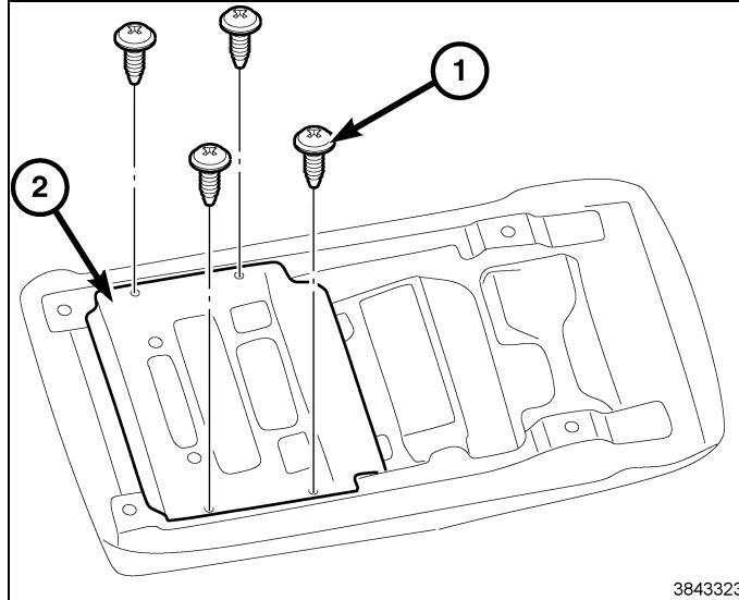
26. **Installation de la trousse de lecteur DVD simple écran dans la console de troisième rangée,** déposer les attaches (1) fixant le support de retenue (2). Déposer le support de retenue.
