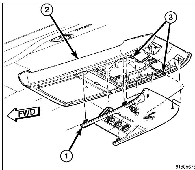
16. Déposer les deux vis (2) fixant l'arrière de la console de plafond (3).
