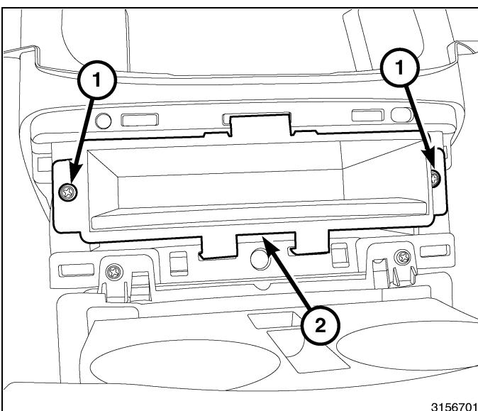
81. **Modelos equipados con consola de suelo completa**, con una varilla de punta plana o similar, haga palanca alrededor del embellecedor de la consola superior (1) para desacoplar los clips de retención.
