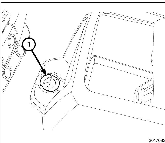
75. Tire de la consola de suelo (2) hacia adelante para desacoplar la lengüeta de retención (1) del soporte del suelo (3).
