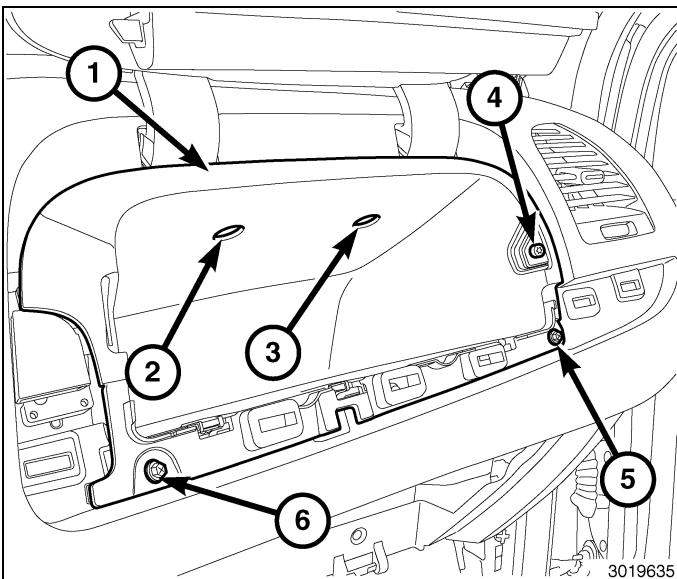
74. **Modèles de véhicules équipés de consoles au plancher de base ou haut de gamme,** déposer l'attache (1) du devant de la console au plancher.
