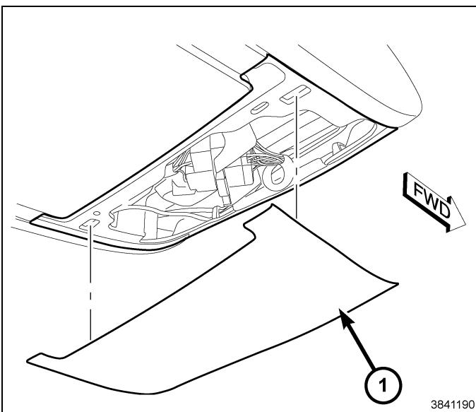
4. Soutenir la console de plafond à l'aide d'un support convenable.
