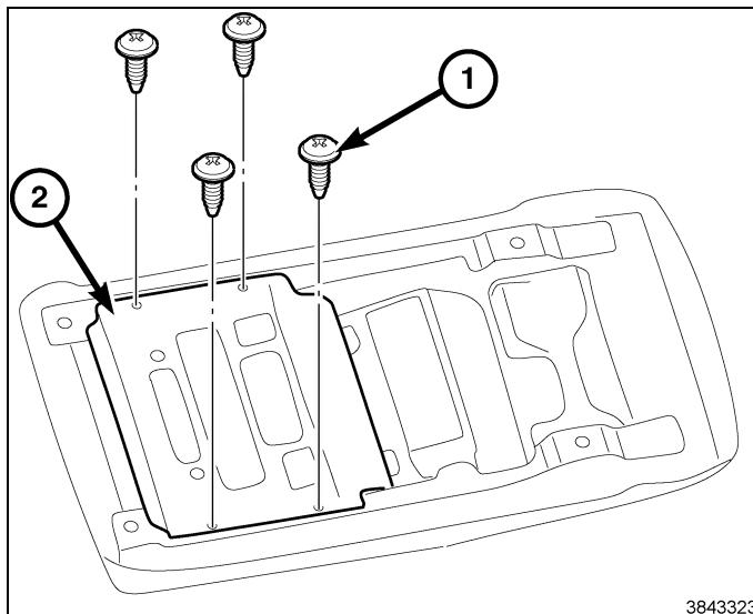
43. **Montaje del kit de pantalla sencilla en la consola de la tercera fila**, gire la consola del techo y coloque el soporte de retención (2).
