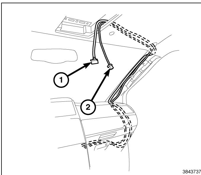
89. À l'aide d'un ruban de tirage ou d'un outil équivalent, insérer le faisceau électrique du lecteur DVD (1, 2) à travers l'ouverture de la cavité de la console de plafond avant et l'acheminer vers l'arrière.
