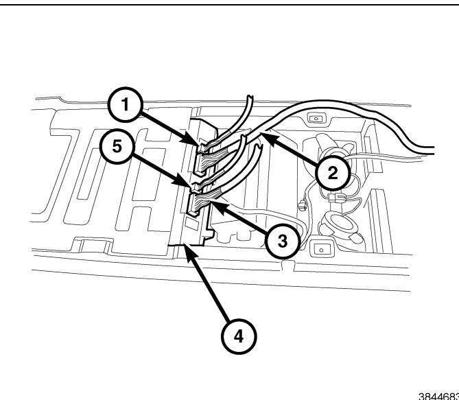
125. Coloque la radio en el panel de instrumentos.
