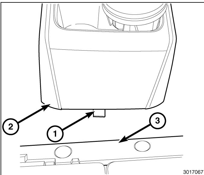
77. **Modèles de véhicules équipés de consoles au plancher de base ou haut de gamme**, déposer les quatre attaches en plastique qui fixent le vide-poches du tableau de bord (1) au tableau de bord.
