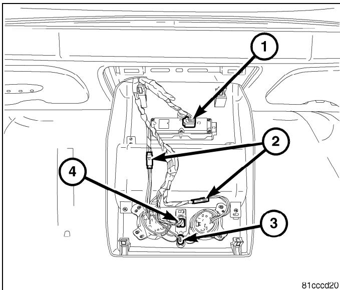
50. À l'aide d'un petit outil levier, déposer les couvercles d'attaches (3) du panneau de garnissage du montant A (1).
