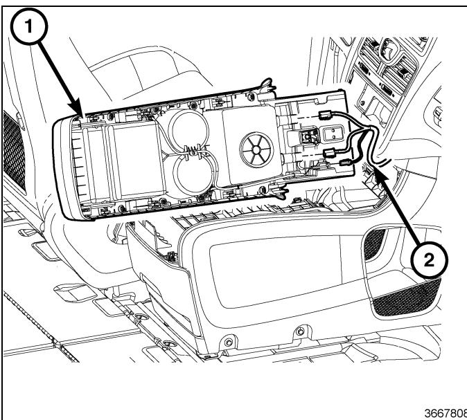
85. Retire los elementos de retención (2) del compartimiento de almacenamiento (1).
