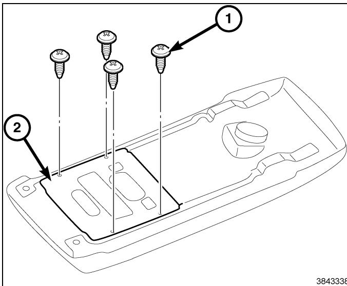
27. Déposer les agrafes (1, 2) du ou des supports de retenue.
