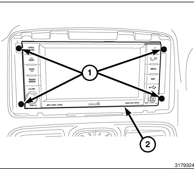
130. Coloque el embellecedor central (1) en el panel de instrumentos y ejerza presión por el contorno del embellecedor para que los elementos de fijación encajen.
