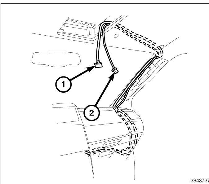
89. Con una guía de cable o similar, realice el tendido de los mazos de cables de alimentación de DVD (1, 2) a través de la apertura en la cavidad de la consola del techo delantera y realice el tendido hacia atrás.
