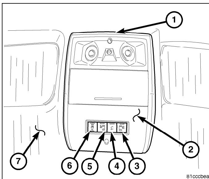
47. Baje la consola de techo lo suficiente como para acceder a los conectores de mazo de cables.
