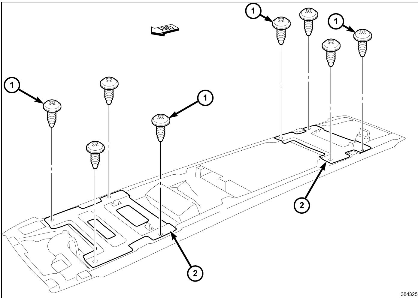
39. Montaje del kit de pantalla doble, gire la consola del techo y coloque los soportes de retención (2).
