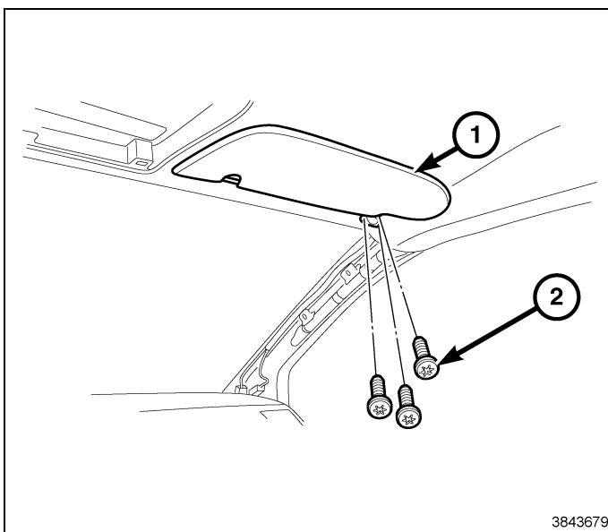
56. Déposer l'attache (2) fixant le support de visière (1) au véhicule. Déposer le support de visière (1).
