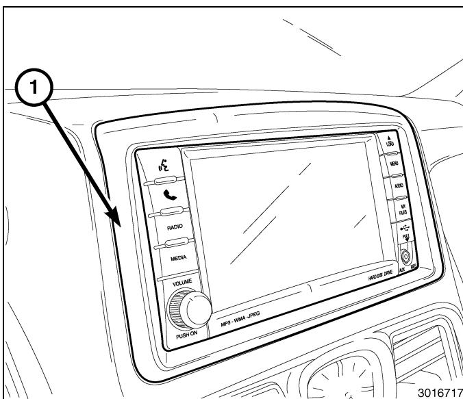
59. Retire los elementos de fijación (1) de la radio (2).
