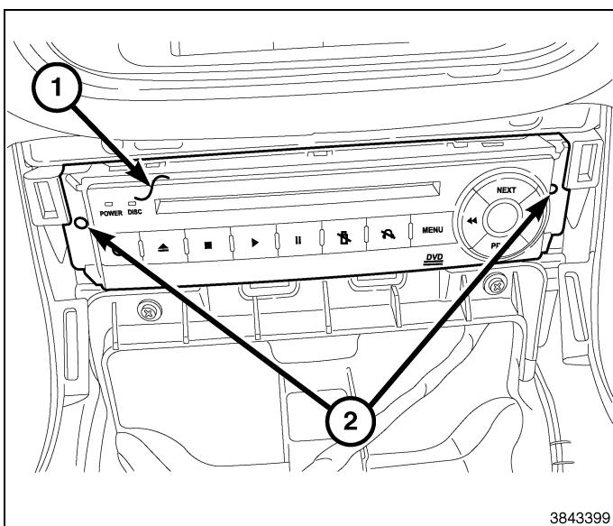
119. **Modelos equipados con consolas de suelo básica o premium**, monte los elementos de retención (2) que fijan el reproductor de DVD al panel de instrumentos. Apriete los dispositivos de fijación con firmeza.
