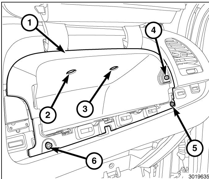
74. **Modelos equipados con consolas del suelo básicas o premium,** desmonte los elementos de retención (1) de la parte delantera de la consola del suelo.
