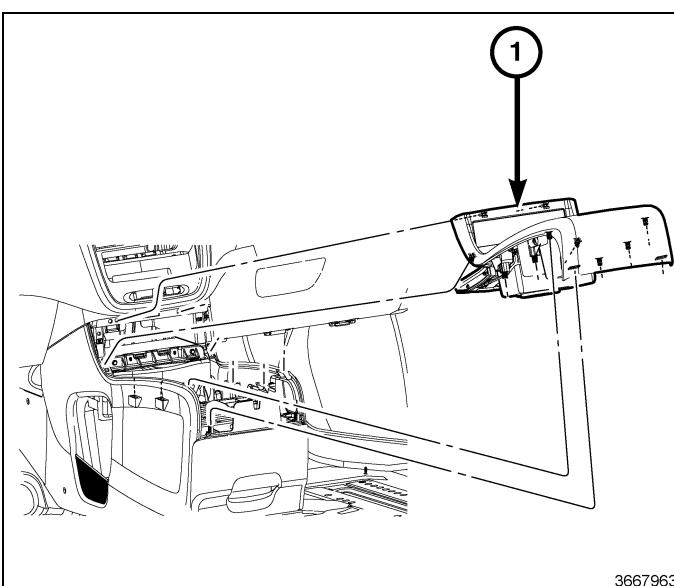
83. Gire el embellecedor de la consola superior (1) y desconecte los mazos de cables (2).
