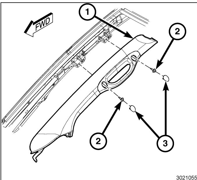
54. Desacople el visor (1) del soporte del visor.
