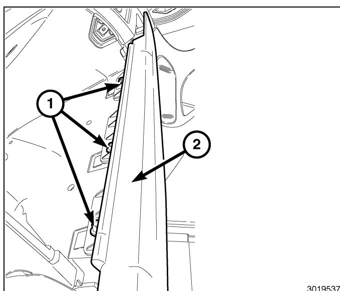
71. Déposer les attaches (2, 3, 4, 5, 6) de la boîte à gants supérieure (1).
