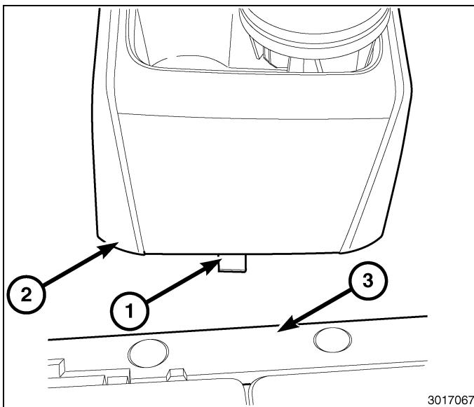
77. **Modelos equipados con consolas de suelo básicas o premium**, desmonte los cuatro elementos de fijación de plástico que fijan el compartimiento del panel de instrumentos (1) al panel de instrumentos.
