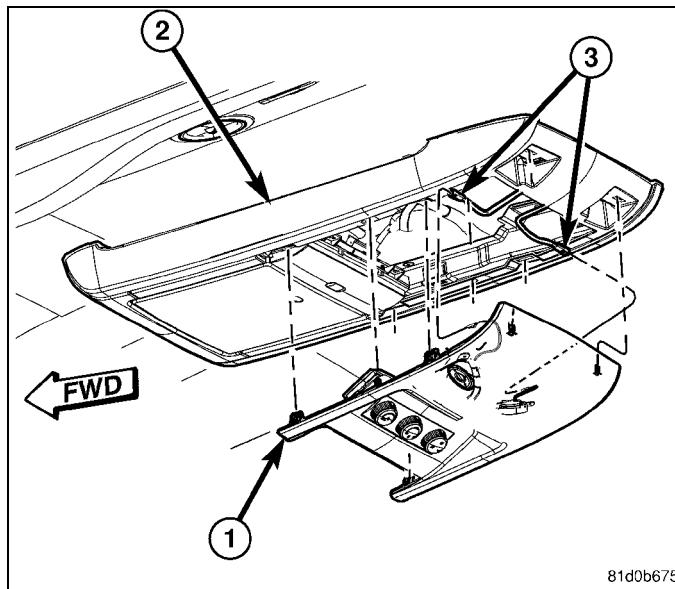
16. Retire los dos tornillos (2) que sostienen la parte trasera de la consola de techo (3).
