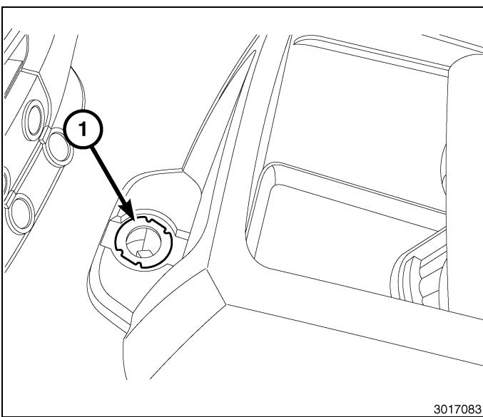
75. Tirer la console de plancher (2) vers l'avant pour dégager la languette de retenue (1) du support de plancher (3).
