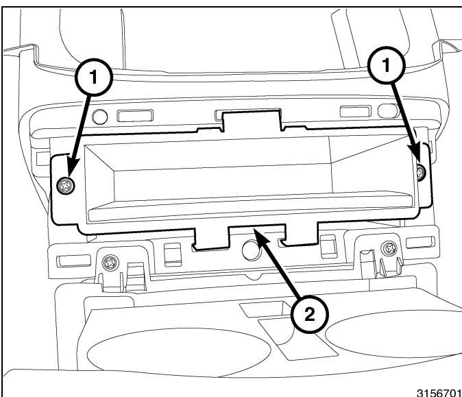
81. **Modèles de véhicules équipés d'une console au plancher pleine dimension**, à l'aide d'une baguette de garnissage ou d'un outil équivalent, faire levier autour du périmètre de l'encadrement supérieur de la console (1) pour dégager les agrafes de retenue.
