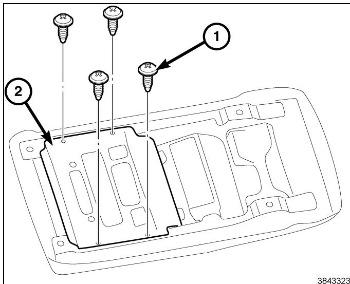
43. Installation de la trousse de lecteur DVD simple écran dans la console de troisième rangée, tourner la console de plafond et placer le support de retenue (2).
